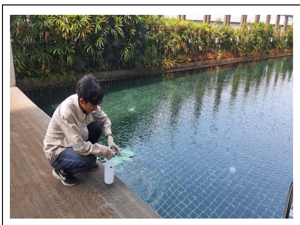
รูปที่ 3.4-2 แสดงการเก็บตัวอย่างน้ำสระว่ายน้ำ
